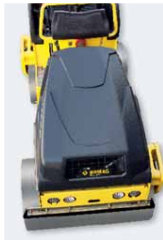
Rulli 100% „filo muro“ grazie ai tam-buri sospesi su un lato e al contemporaneo disassamento di 60 mm.
